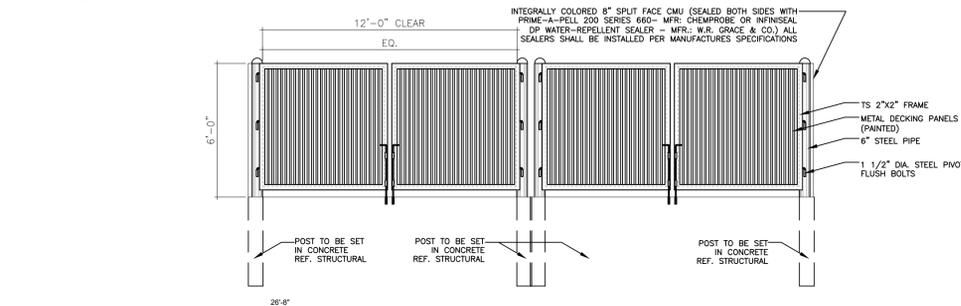
3 DUMPSTER ENCLOSURE ELEVATION
