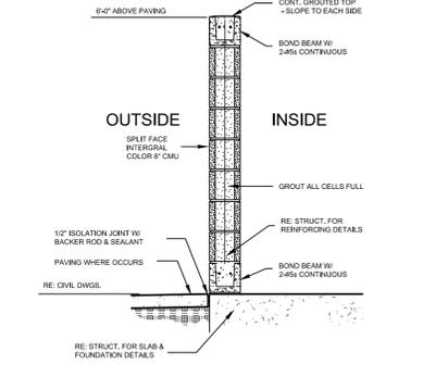
4 DUMPSTER ENCLOSURE WALL SECTION
